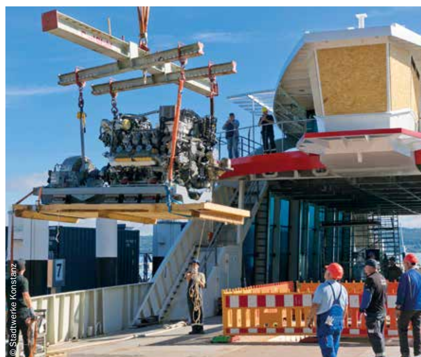
Neues Fährschiff: Die Bauarbeiten am neuen Fährschiff der Stadtwerke Konstanz gehen gut voran. Jüngst wurde der erste Antriebsmotor eingebaut. Außerdem hat der Innenausbau der Fahrgasträume begonnen. Wenn die Arbeiten weiter nach Plan verlaufen, soll das Schiff Anfang 2023 in die Erprobung gehen.
