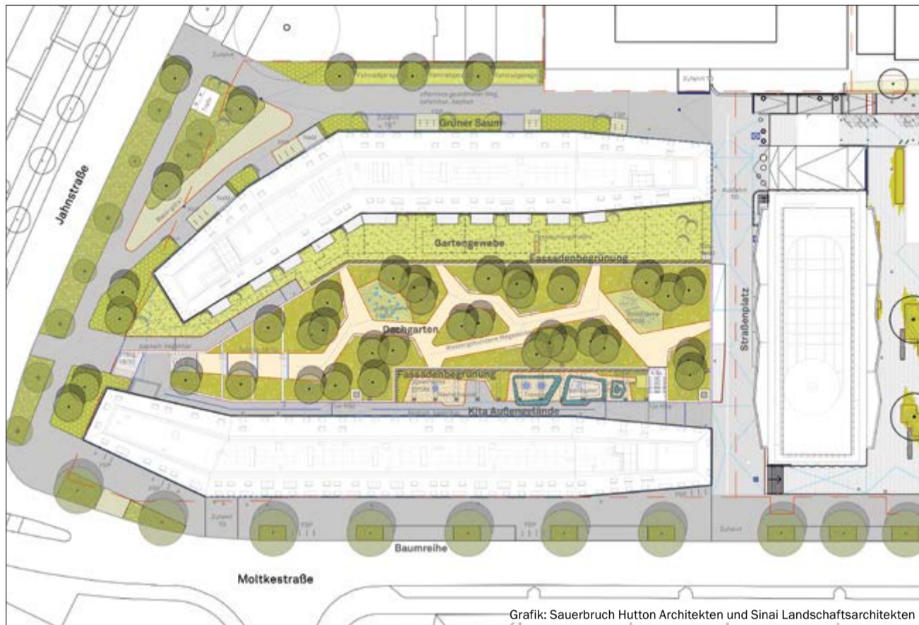
Der Plan zeigt das künftige Telekom-Areal mit dem ehemaligen Fernmeldehochhaus (rechts) und den zwei neuen länglichen Baukörpern (weiß). Dazwischen liegt das heutige Technikgebäude. Geplant ist, dass das oberste Geschoss dieses Gebäudes abgetragen wird. Auf der (bisherigen) Betonfläche soll ein Dachgarten mit viel Grün entstehen.
